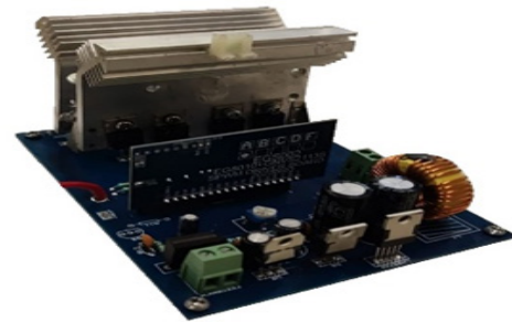
Fig. 7 Inversor monofásico diseñado en ISIS PROTEUS.
