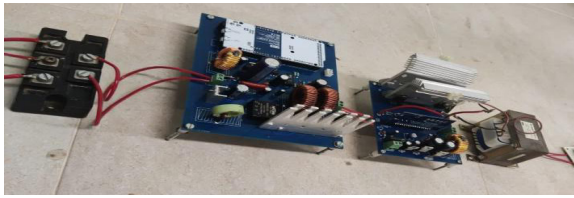
Fig. 8 Sistema electrónico de potencia desarrollado para la aplicación en un aerogenerador de baja potencia.
