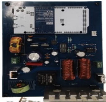
Fig. 3 Convertidor buck desarrollado para aplicaciones eólicas.
